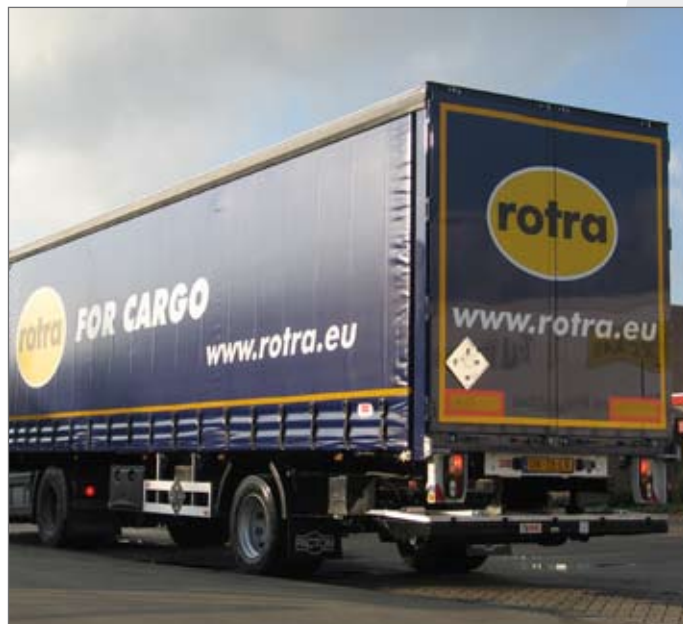
Uitvoering met onderschuiflaadklep en vlakke achterdeuren
