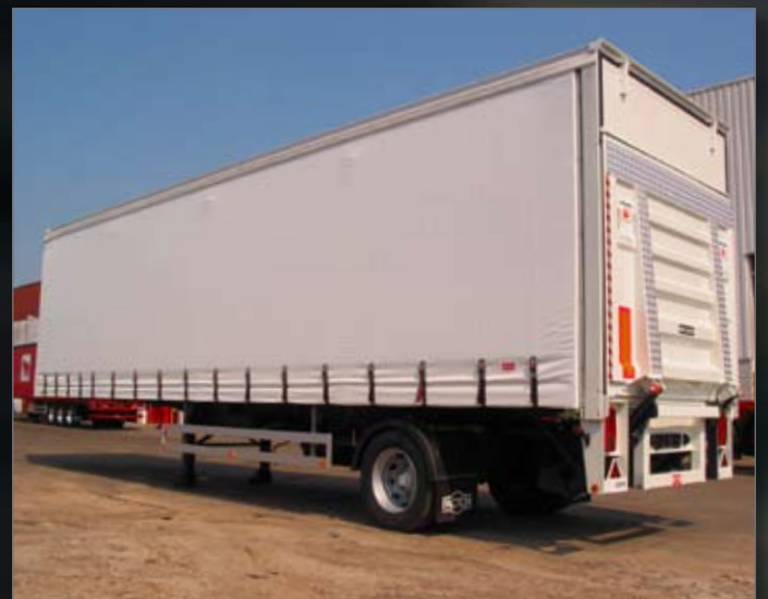
City X-press uitgevoerd met achtersluitende laadklep
