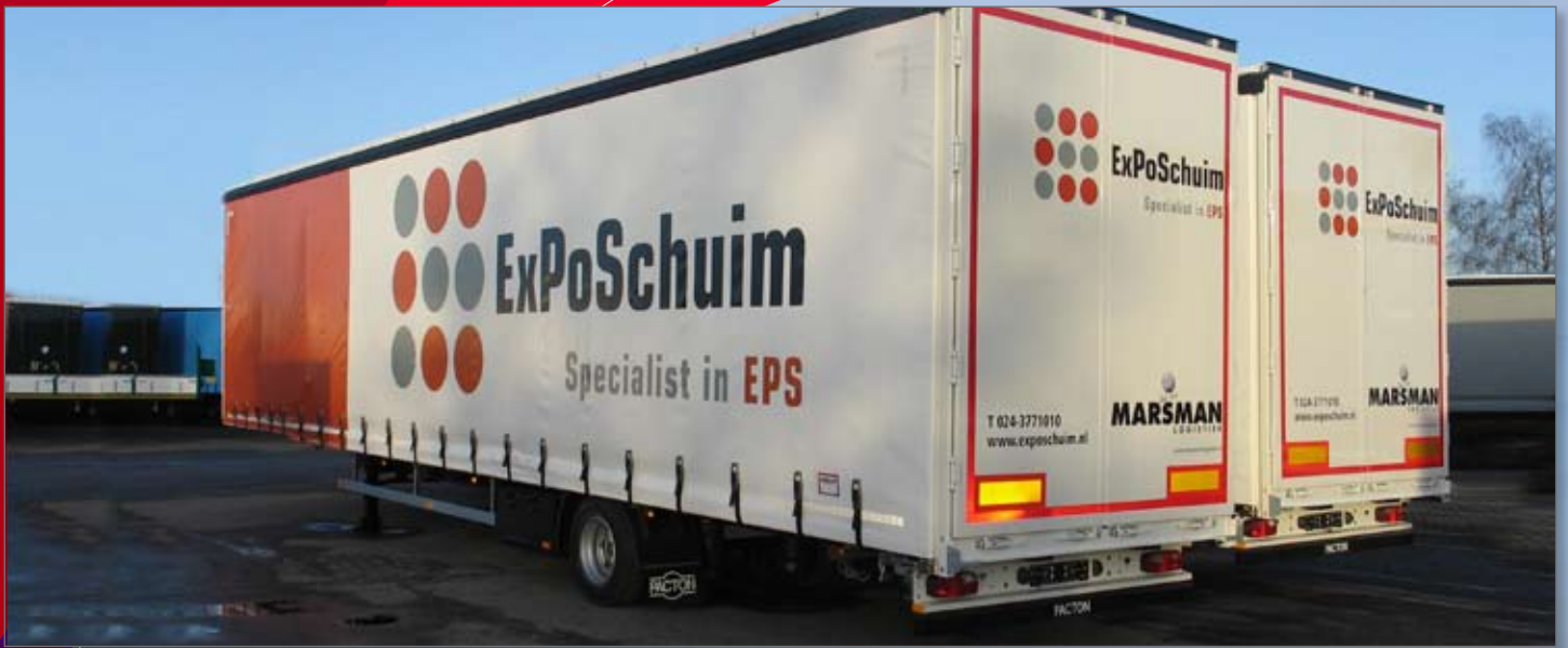
13.600 mm uitvoering met starre as ter behoeve van volumetransport
